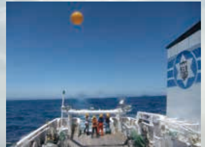
2012年7月 鹿島沖 太平洋上の観測船(勢水丸)より 気象ゾンデ放球のようす
